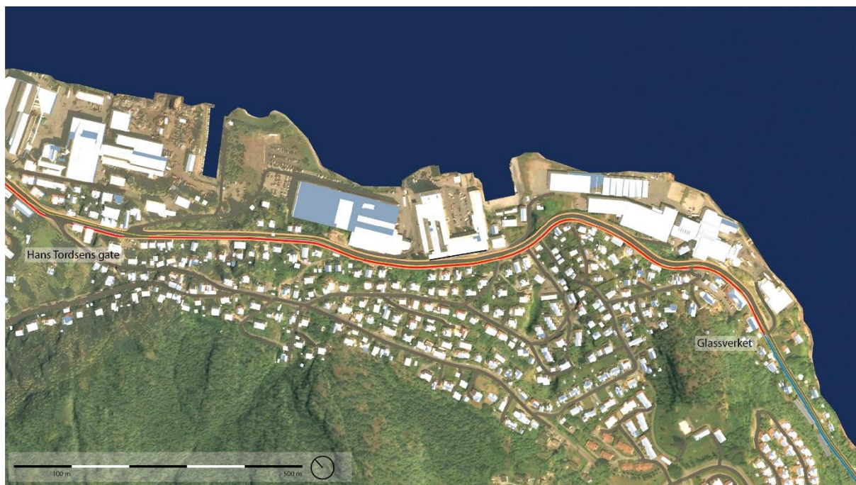
Figur 55: Alternativ 1 - delstrekning 1d-1. Løsninger viser ny sykkelvei med fortau på sørsiden av Svelvikveien, mellom Hans Tordsens gate og Glassverket/Svelvikveien 91. Løsningen medfører at senterlinje vei må forskyves på hele strekningen. Dersom samme bredde/standard skal gjennomføres på hele strekningen, kommer løsningen i konflikt med tre eksisterende næringsbygg.
