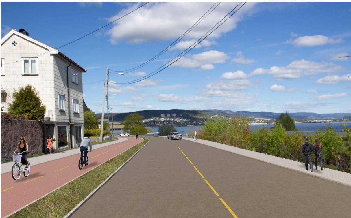
Figur 68: Illustrasjonen viser alternativ 1 ved Glassverket (delstrekning 1d). Løsningen viser sykkelvei med fortau på sør/vestsiden av Svelvikveien.
