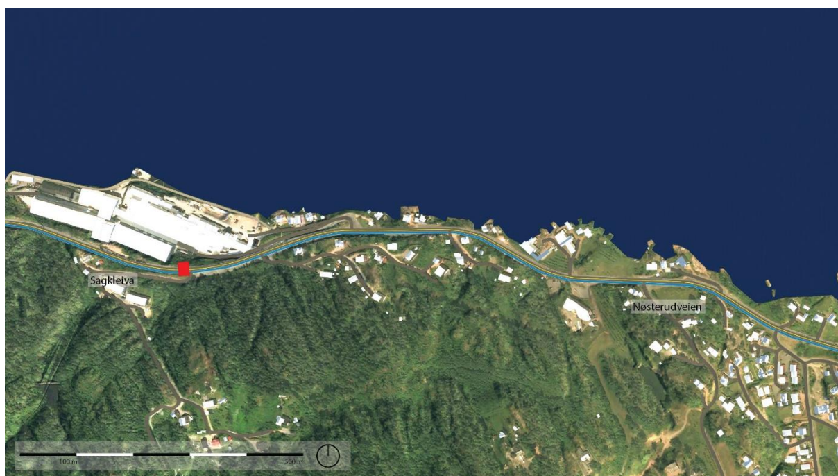
Figur 60: Alternativ 1 - delstrekning 3a. Løsningen viser ny GS-vei (med Svelvik-ellipse) på sørsiden av Svelvikveien, mellom Sagkleiva og Nøsterudveien. Senterlinje vei beholdes uendret.
