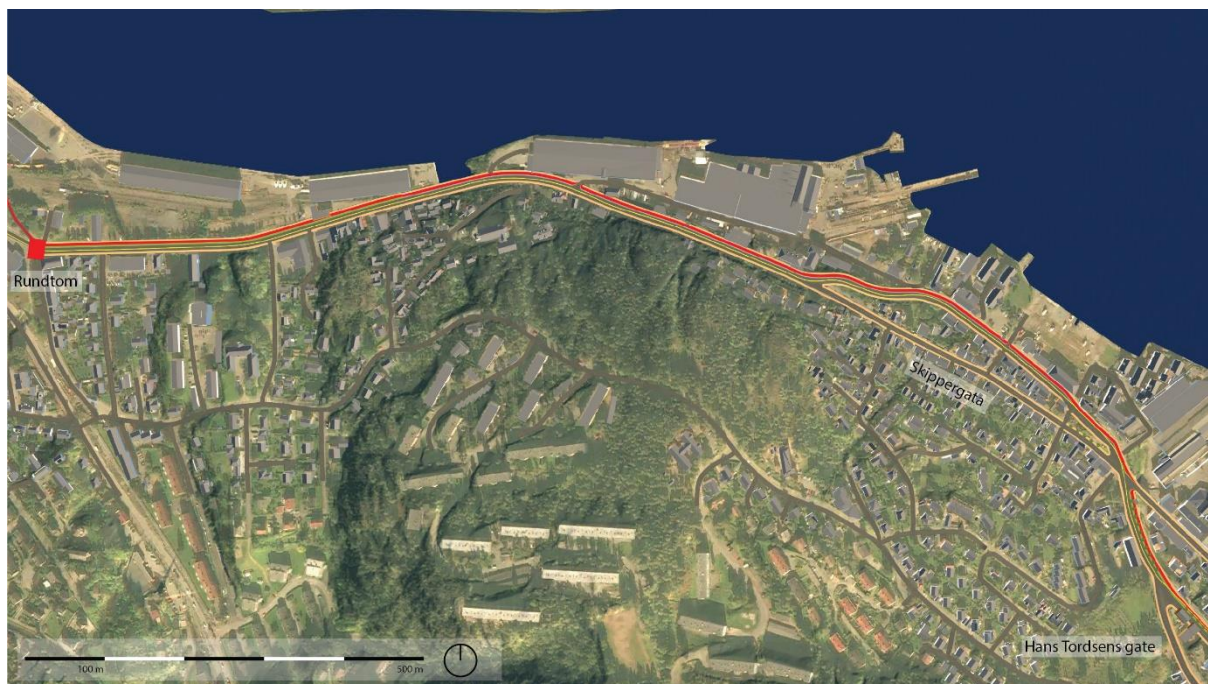
Figur 70: Alternativ 2 - delstrekning 1a, 1b og 1c. Løsninger viser ny sykkelvei med fortau på nordsiden av Svelvikveien, mellom Rundtom og Hans Tordsens gate. Senterlinje vei beholdes uendret, med unntak av en ca. 100 m lang strekning. Dersom samme bredde/standard skal gjennomføres på hele strekningen, kommer løsningen i konflikt med to eksisterende næringsbygg og en eksisterende bolig.
