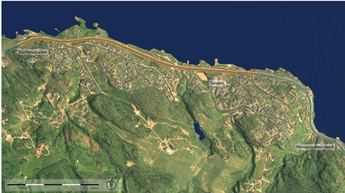
Figur 72: Alternativ 2 - delstrekning 3b. Løsningen viser ny sykkelvei med fortau og trerekker på sørvestsiden av Svelvikveien, mellom Nøsterudveien og Sørjordet. Senterlinje vei beholdes uendret. På resten av strekningen, mellom Sørjordet og Nesvangveien nord, beholdes dagens løsning (GS-vei) uendret.
