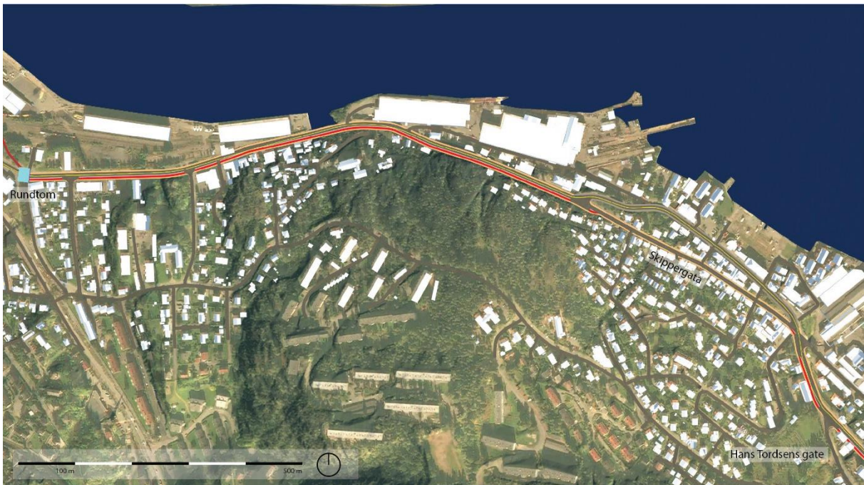
Figur 54: Alternativ 1 - delstrekning 1a, 1b og 1c. Løsninger viser ny sykkelvei med fortau på sørsiden av Svelvikveien, mellom Rundtom og Skippergata nord og mellom Skippergata sør og Hans Tordsens gate. Løsningen medfører at senterlinje vei må forskyves på store deler av strekningen. Dersom samme bredde/standard skal gjennomføres på hele strekningen, kommer løsningen i konflikt med eksisterende næringsbygg. Langs delstrekning 1b (Skippergata) beholdes dagens løsning (sykling i blandet trafikk) uendret.
