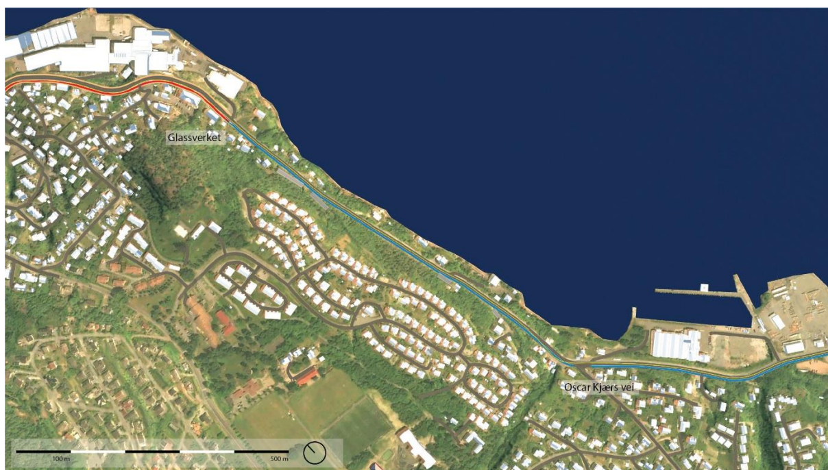
Figur 56: Alternativ 1 - delstrekning 1d-2. Løsningen viser ny GS-vei (med Svelvik-ellipse) på vestsiden av Svelvikveien, mellom Glassverket/Svelvikveien 91 og Oscar Kjærs vei. Løsningen medfører at senterlinje vei må forskyves over en ca. 100 m lang strekning.
