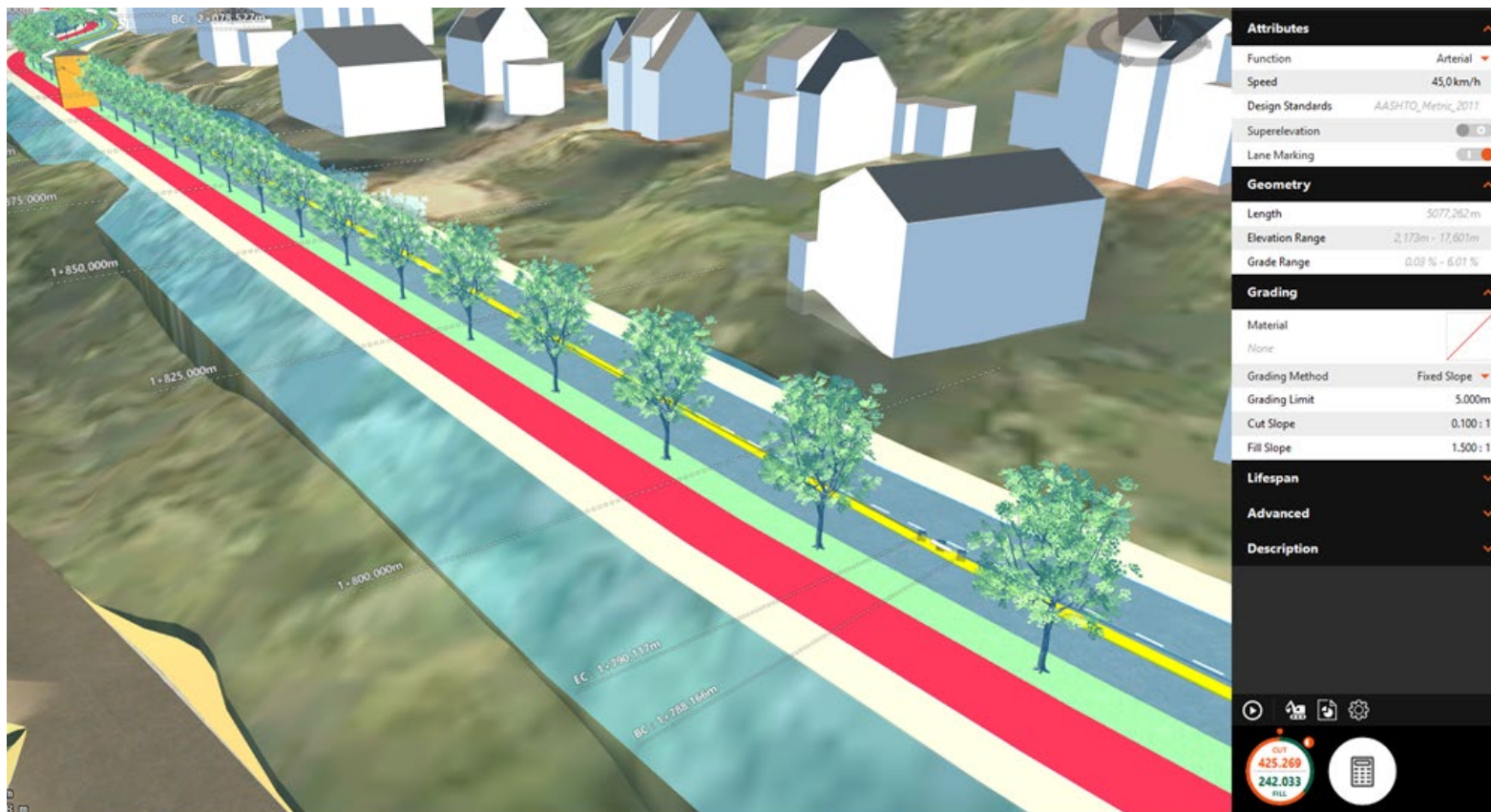
Figur 1. Eksempelbilde arbeidsprosess. Her er ulike vegelementer lagt inn, og nederst på høyre side kommer det fram hvor mye masser som må fjernes og fylles på for denne løsningen.
