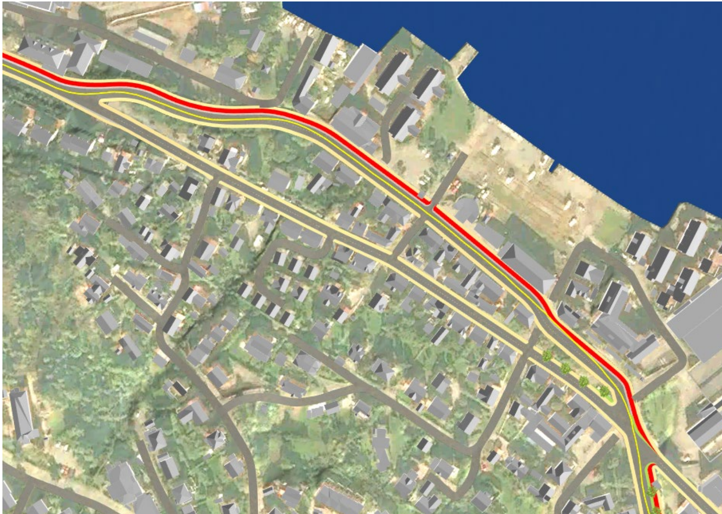
Figur 6. Med sykkelanlegget på sjøsiden i alt 2, ble det også nødvendig å fortsette sykkeltilretteleggingen på delstrekning 1b langs Svelvikveien, for å unngå et krysningspunkt over til Skippergata i hver ende. Dette medfører også en mer helhetlig og gjennomgående løsning.
