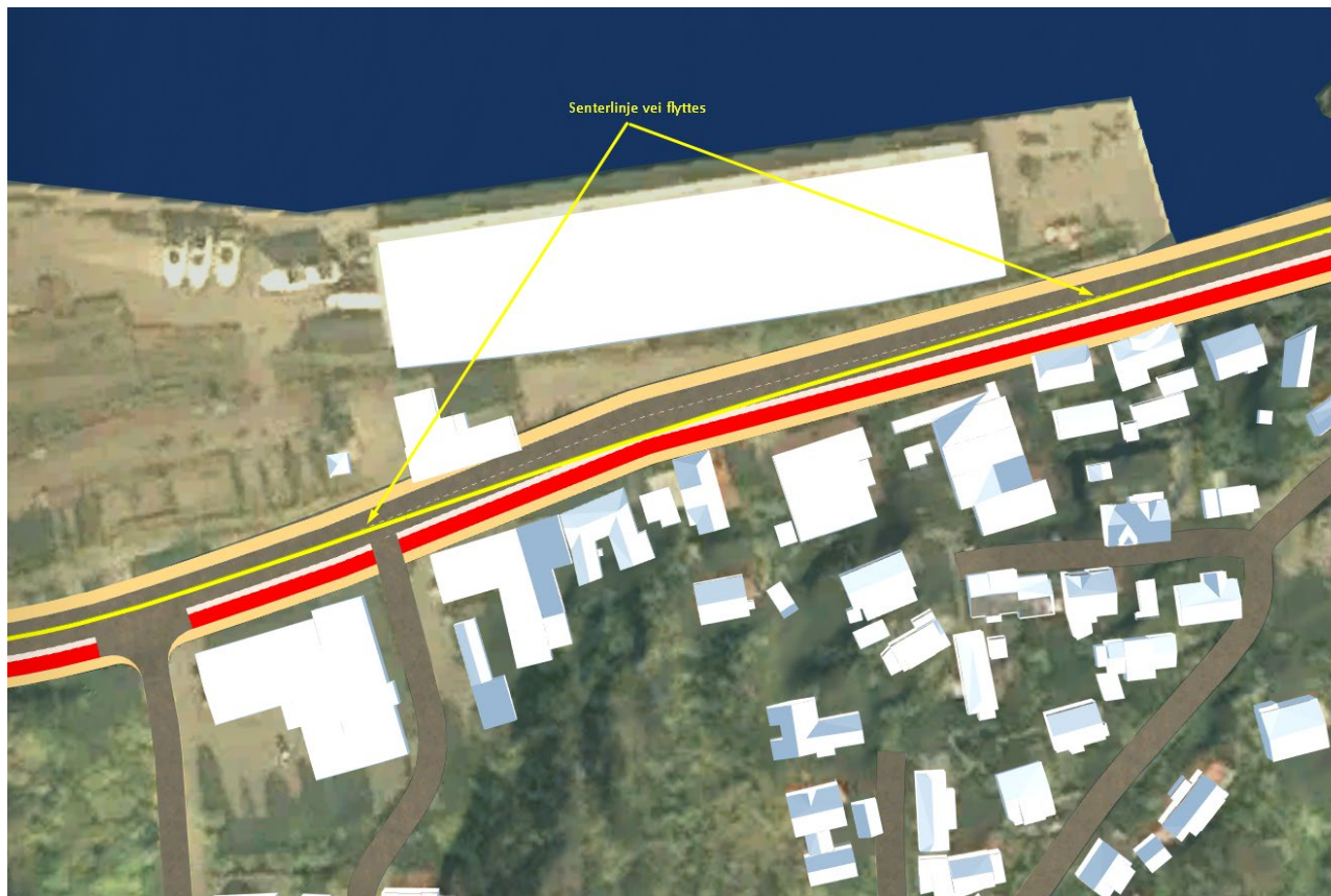
Figur 2. Forskyving av senterlinje delstrekning 1a alternativ 1.
