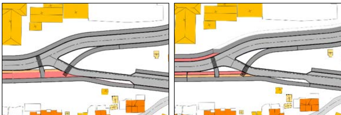
Figur 51 Utsnitt av vurderte kryssløsninger for vestre kryss Havnegata/Skippergata. Til venstre vises sykkelvegløsning, og til høyre vises løsning med sykkelfelt
