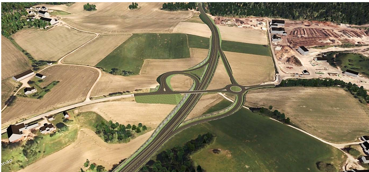
Figur 22 Forslag til nytt planskilt kryss ved Lindum (3D modell, Statens vegvesen, 2015)
