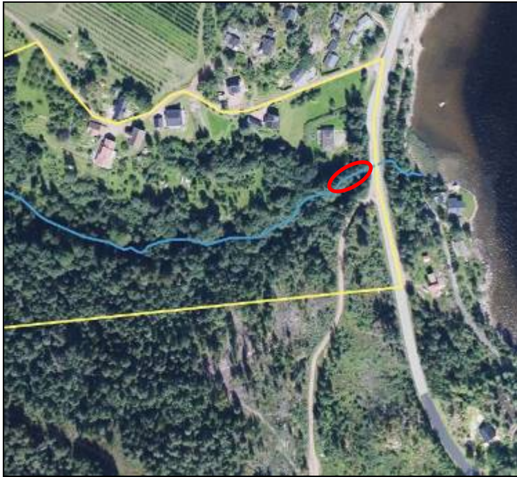
Figur 5-7. For å redusere risikoen for at partikkelavrenning fra deponiet forringer naturverdiene og vannforekomsten foreslås det å anlegges en rensedam (rødt omriss) nær bekkens (blå strek) utløp.
