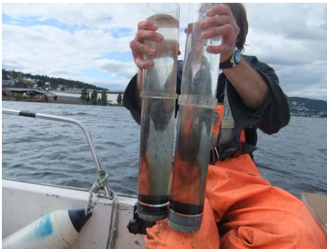
Figur 4 Prøvetakning med sedimentfeller. Nederst i oppsamlingssylindrene observeres det oppsamlede materialet.
