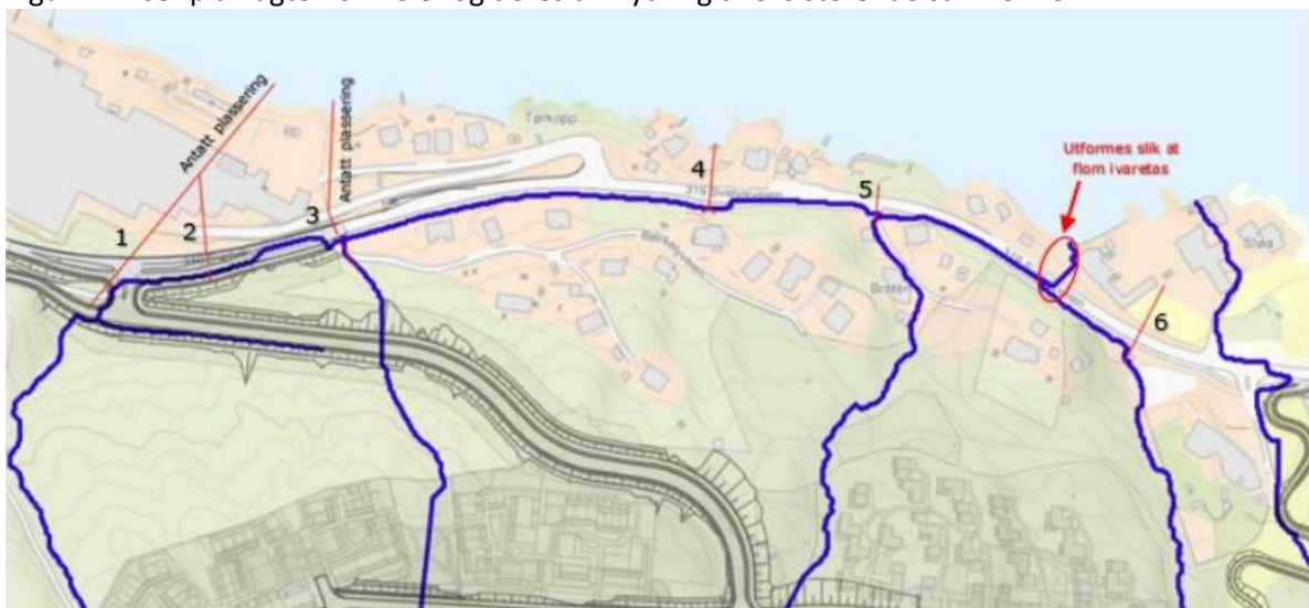
Figur 77 viser flomveier og tilknytning til eksisterende stikkrenner.
