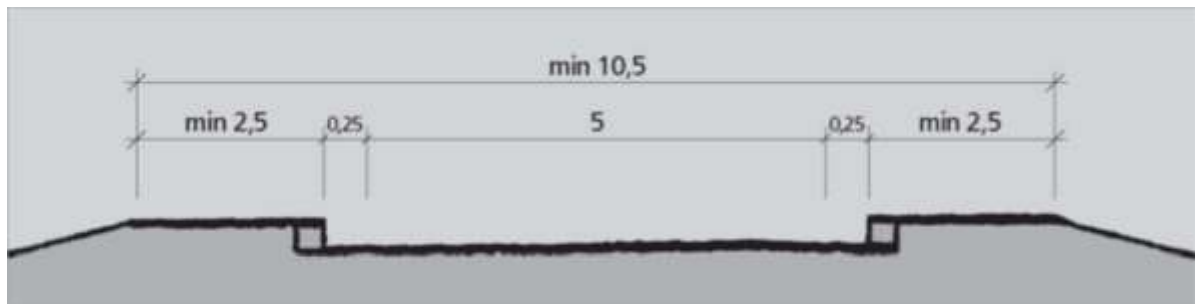
Figur C.15: Tverrprofil Sa1 (alternativ 2) minimum 10,5 m vegbredde inklusive fortau (mål i m)
