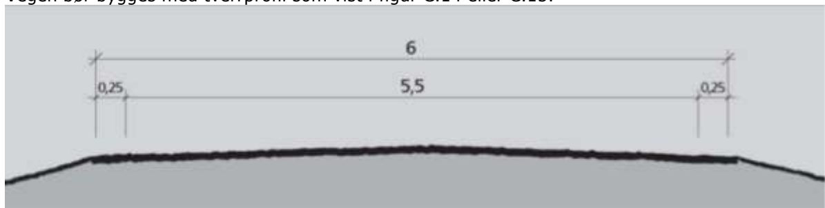
Figur C.14: Tverrprofil Sa1 (alternativ 1) 6 m vegbredde (mål i m)
